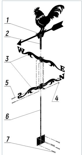
Рис. 1. **Сборка флюгера.** 1 – флюгарка; 2 – втулка флюгарки с подшипниками; 3 – направления сторон света; 4 – гайка; 5 – винт; 6 – ось флюгера; 7 – саморезы.
