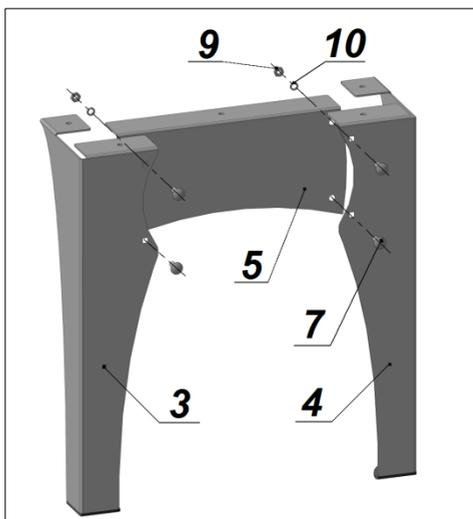
**Шаг 3.** С помощью болтов поз.6, гаек поз.9, стопорных шайб поз.10 соединить доски с ножками скамьи.
