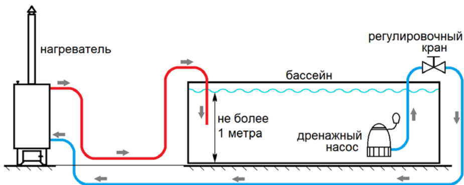
Рисунок 2. Схема подключения нагревателя на одном уровне с бассейном.
