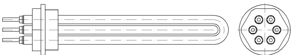
**Рисунок 3. Трубчатый электронагреватель блочный (ТЭНБ).**
