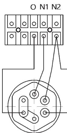
**Рисунок 2. Схема однофазного подключения электрокотла**
