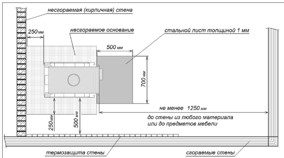
Рисунок 3. Установка печи в помещении (вид сверху).
